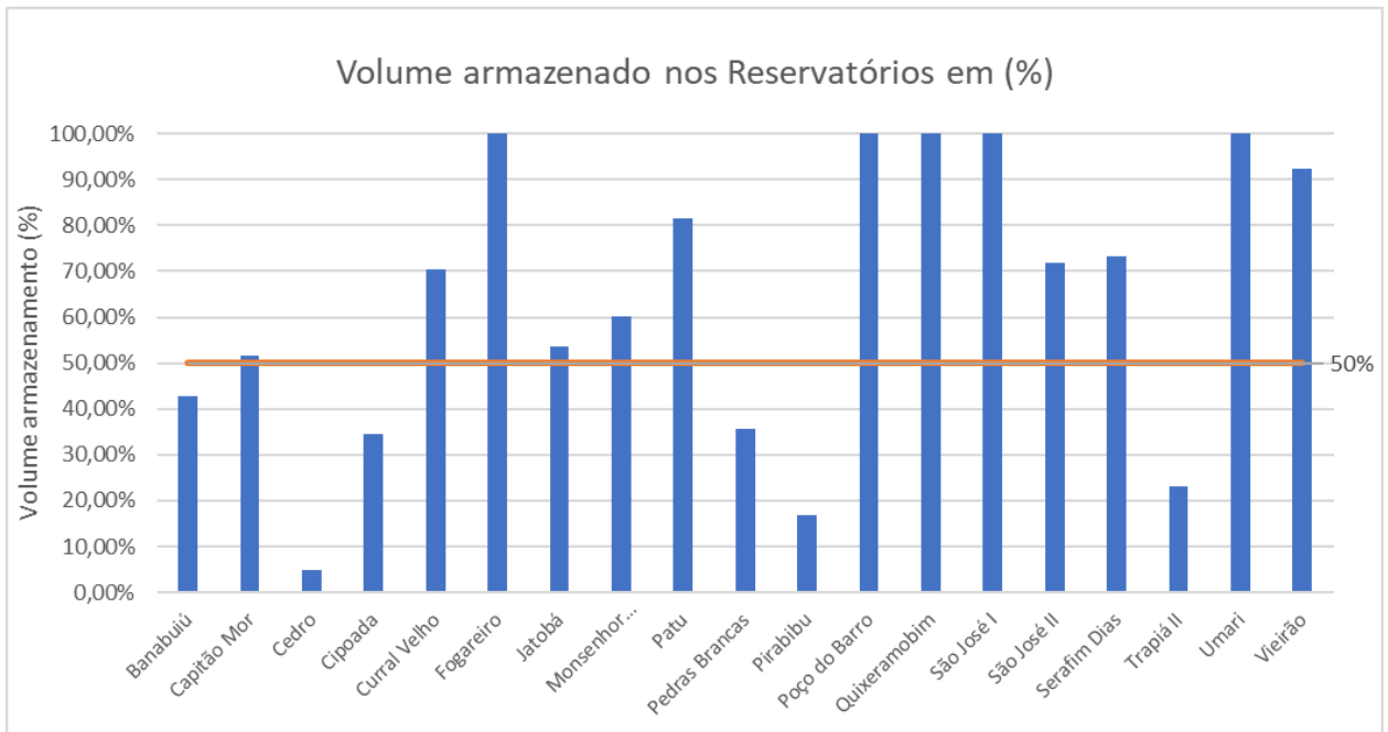
Figura 3.2 – Volume dos reservatórios em % - Bacia do Banabuiú.
